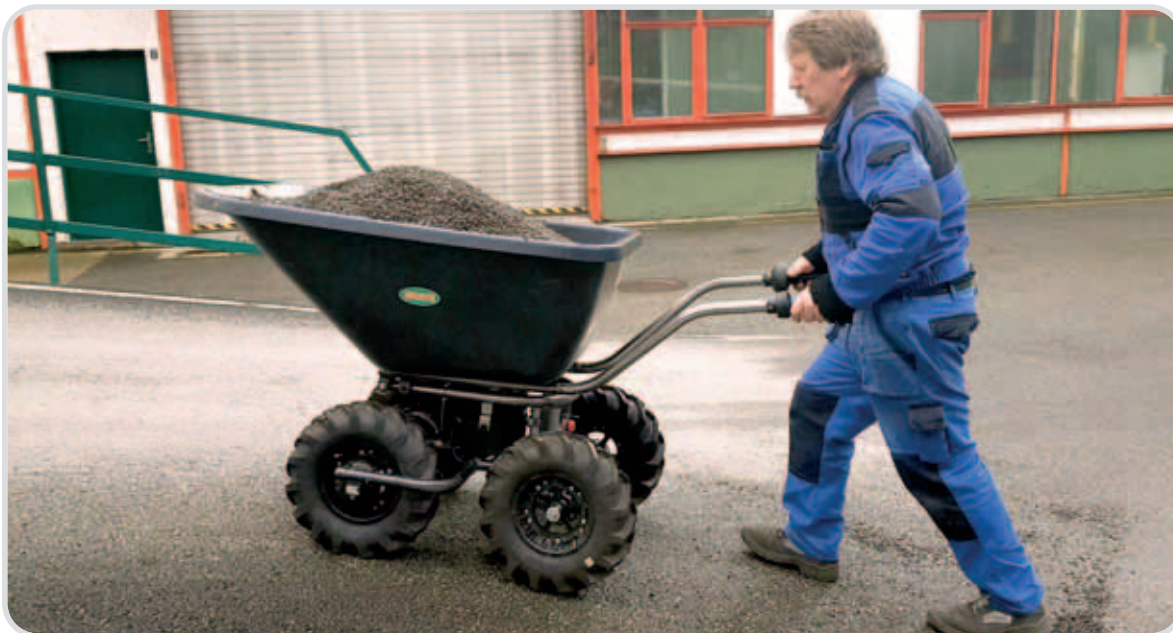
Terénní verze čtyřkolky 4x4, 4x2, pro přepravu objemnějších materiálů v náročném terénu.
