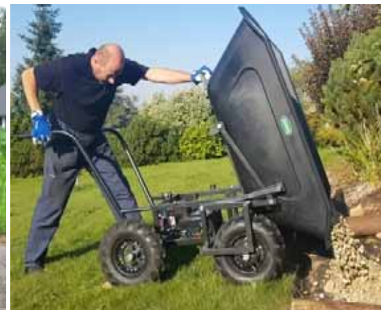
Koňáčka s vyklápěcím mechanismem - 300 kg
